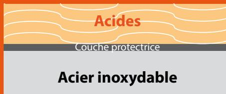
Lorsqu'un acier inoxydable est placé en contact prolongé avec un acide fort, la couche protectrice formée à la surface de l'acier inoxydable se dissout rapidement.
